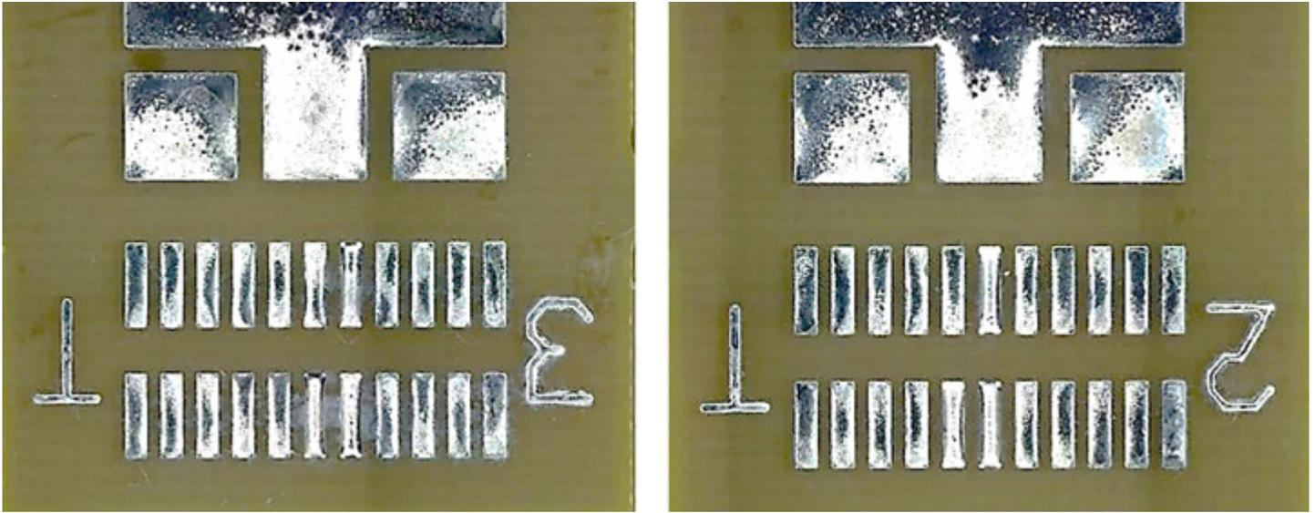
图 5：符合 J-STD-003C 附修订本 1&2 规范的边缘浸焊测试
