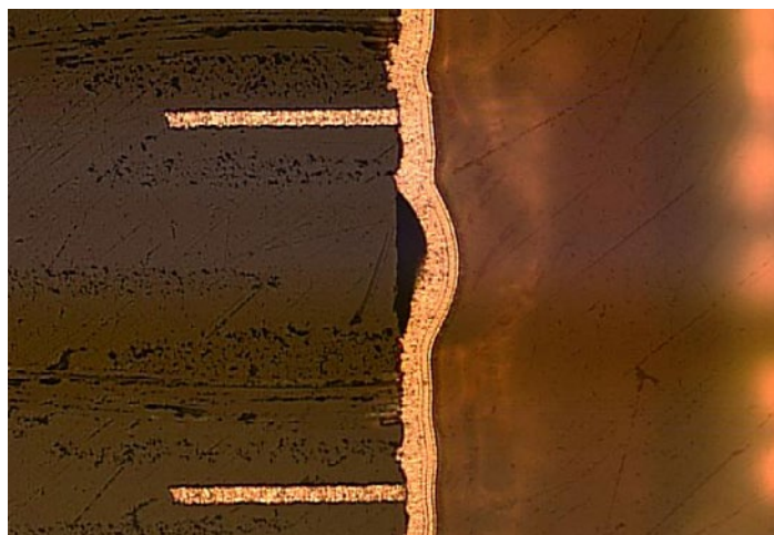
图6：孔壁分离，通孔侧壁的镀铜起泡或凸起
