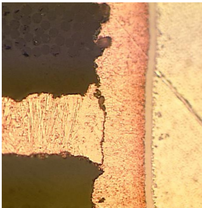
图7：未从互连中去除钻孔脏污引起的细线互连缺陷
