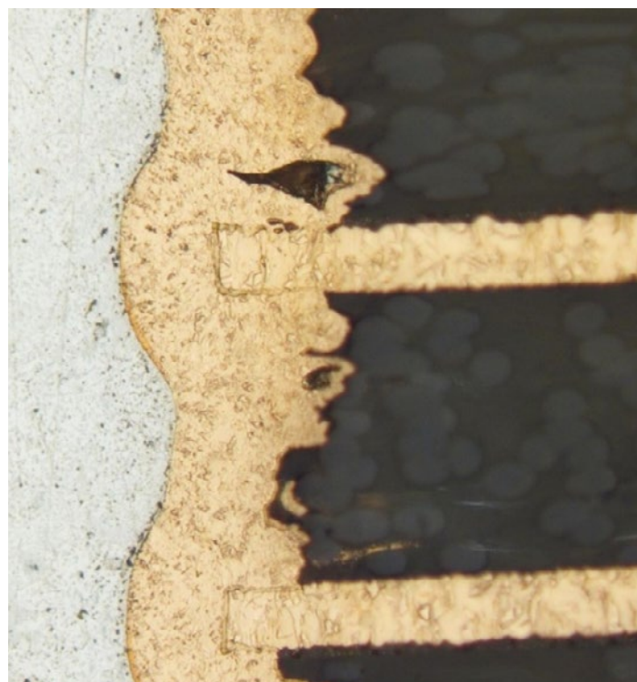
图2：过度凹蚀，导致镀层褶皱，凹蚀超出0.003英寸
