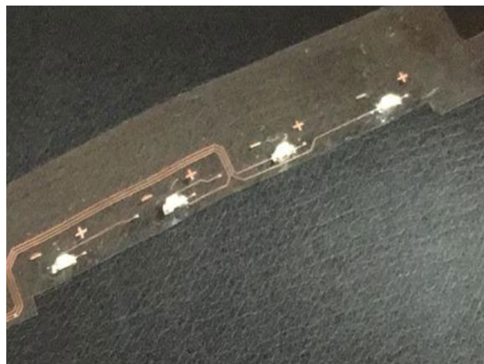
图为透明挠性电路示例。通过焊接安装几个LED
