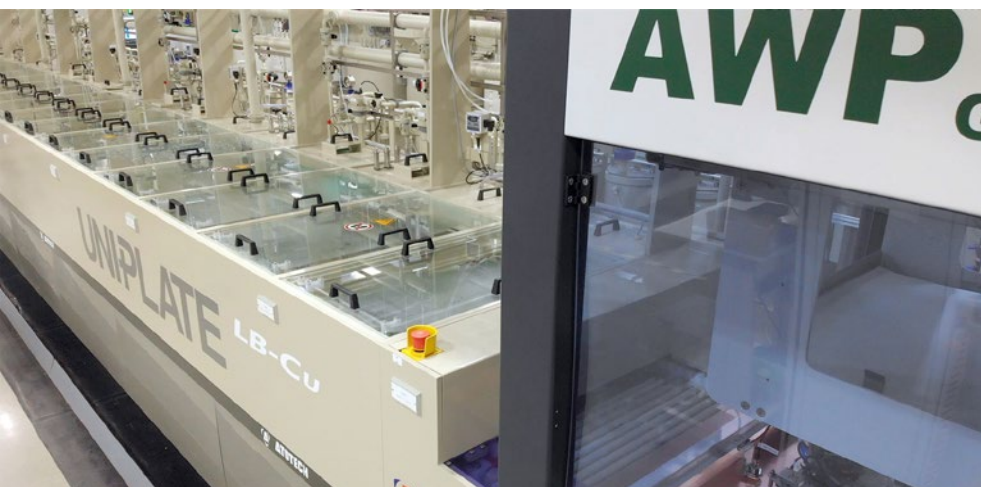
GreenSource Fabrication工厂内的Atotech化学镀铜生产线 (Uniplate LB) 和电镀铜设备 (Uniplate IP2)，摄于2018年。
