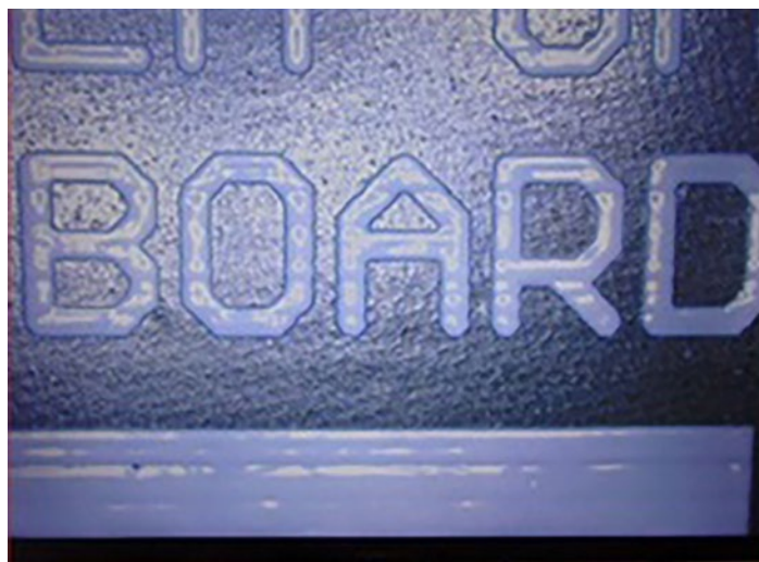
图3:LED固化面板具有良好的标识附着力
