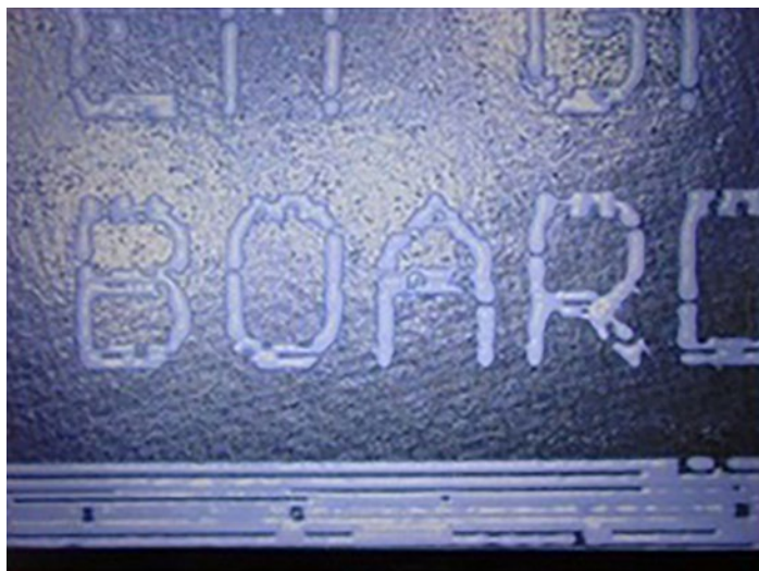
图2:蒸汽灯固化的面板,标识附着力差
