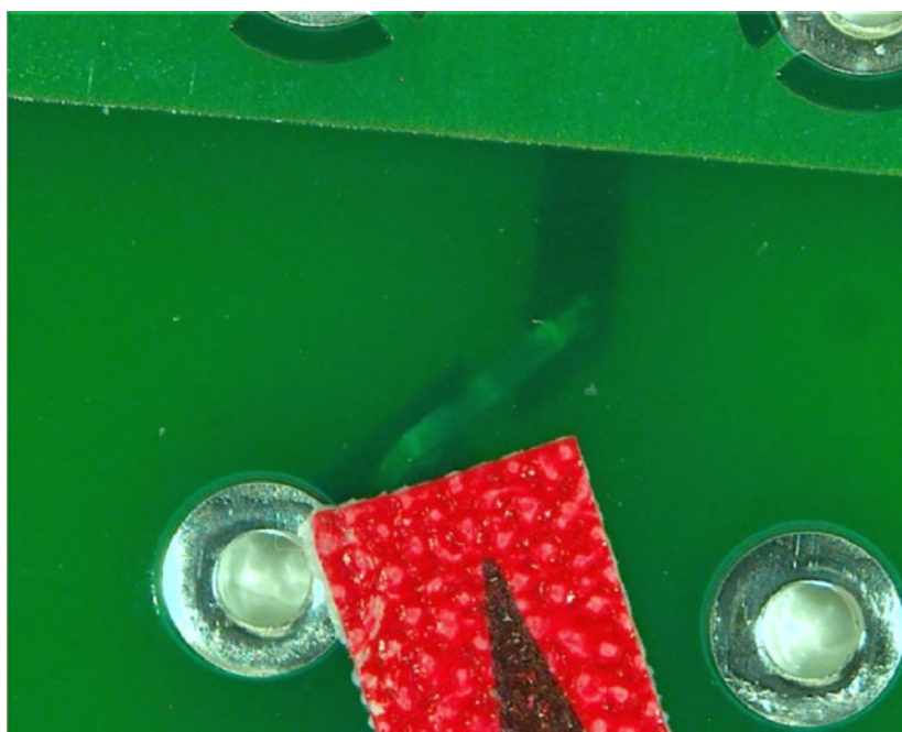
图 5：在放大镜下从表面看维修后的内层
