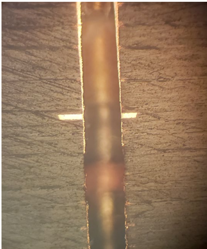
图 8：通过四线开尔文测试法测出的铜空洞
