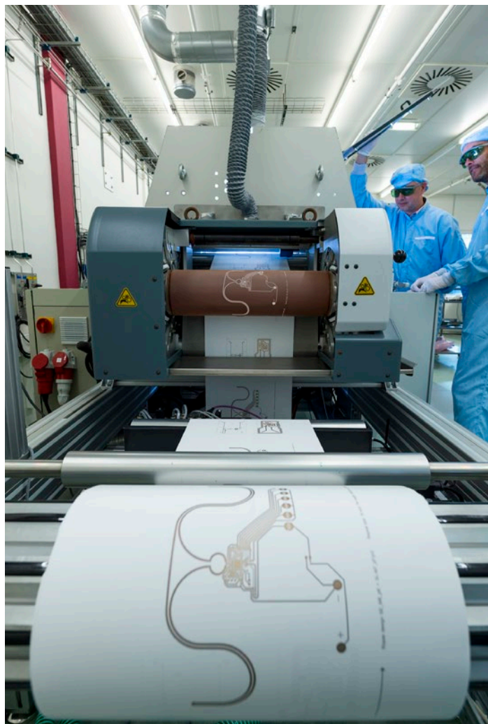
图 1：在膜上卷对卷印制电路，最高速度可达每分钟 60 米
