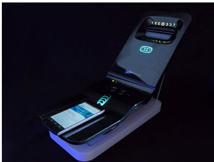
图 3：用于汽车应用的热成型中控台，包括电容式触摸、OLED 集成和 NFC 读出
