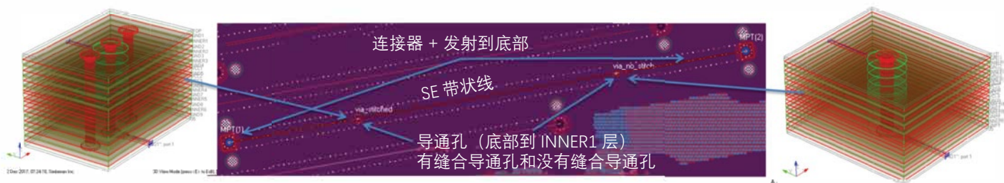
图 4：两个导通孔，一个导通孔带有两个缝合孔，另一个则不带有缝合孔
