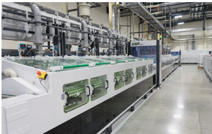
图 2：AWP 安装在 GreenSource Fabrication 的蚀刻生产线
