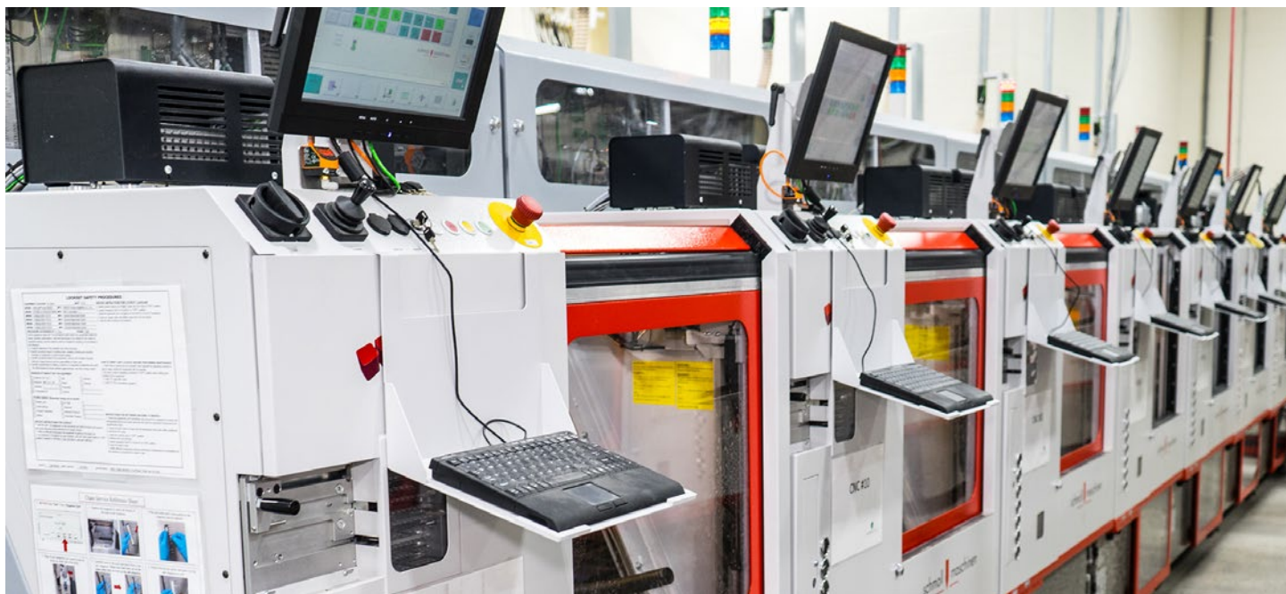
图 8：这组 Schmolz Modul 系列钻机配备了 3D 背钻槽
