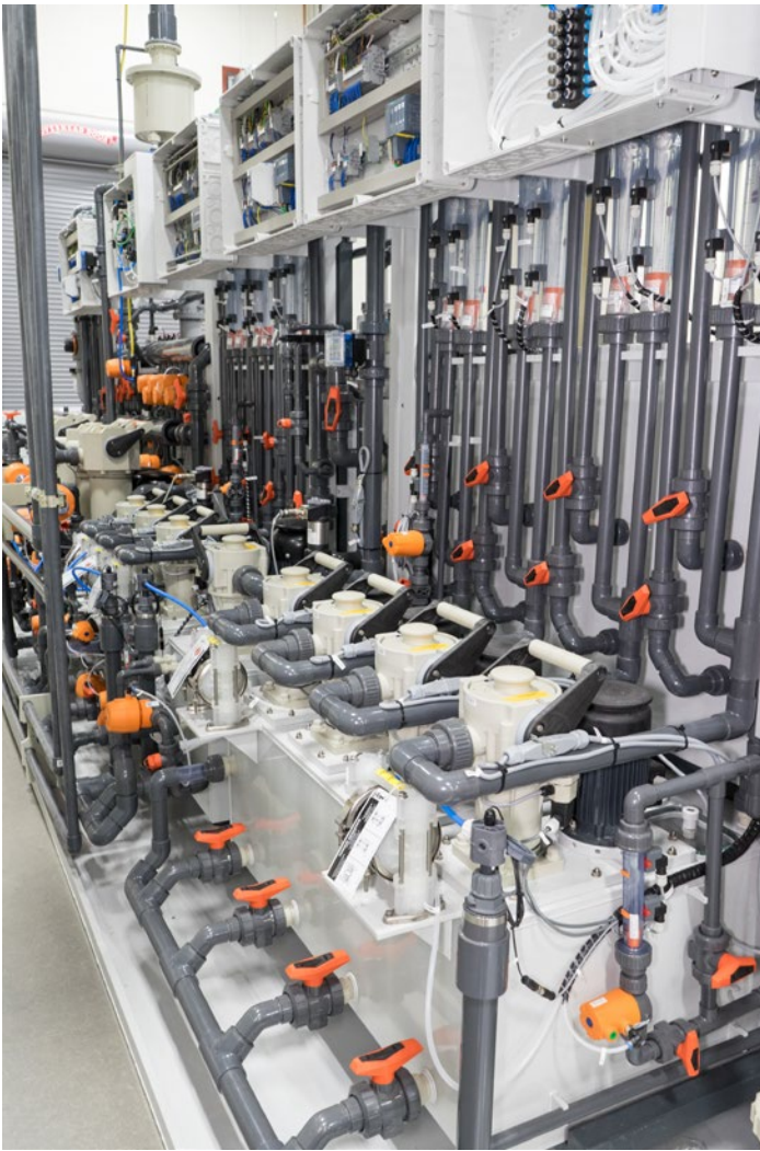
图 7：管道、控制装置和槽体设计实现了 AWP 对化学品和环境的管控
