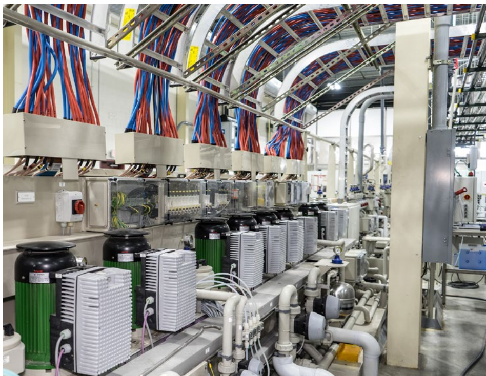
图 6：泵和冷凝器可保证 Atotech 生产线实现化学配方的动态且精密控制，同时可收集烟雾。这两大功能是实现零排放，可加工任意批量产品的关键
