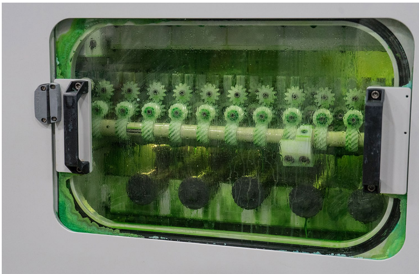
图 3：蚀刻工艺采用底部蚀刻的方式获得了更高的效率
