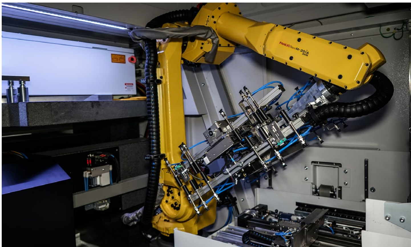
图 1：定制的 Schmoll Maschinen Laser Master 配备有双机械臂，可自动翻转面板
