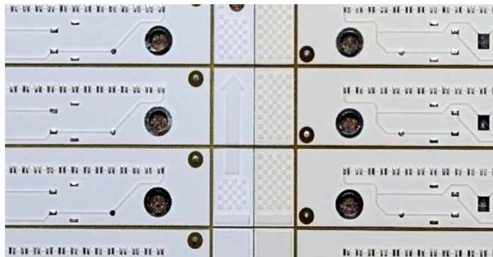
图 3：经过多次回流周期后，阻焊膜接近棕色
